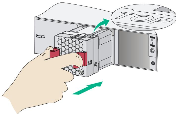
交换机初次上电时，还需要在交换机上使用 **fan prefer-direction** 命令配置设备的期望风道风向与所选风扇风向一致，否则系统会输出 **Trap** 和 **Log** 信息进行告警。缺省情况下，交换机的期望风道风向与 **LSPM1FANSA** 风扇风向一致，即电源侧进风、端口侧出风。有关 **fan prefer-direction** 命令的详细介绍请参见交换机配套配置指导和命令参考。
