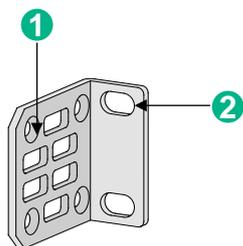
(1): 安装挂耳到交换机的螺钉孔
