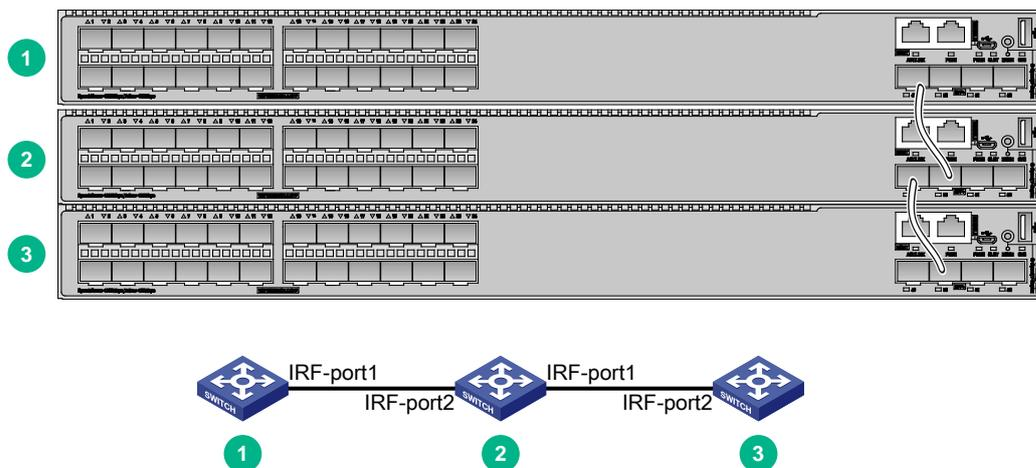
图5-3 IRF 环型连接方式及对应的拓扑示意图
