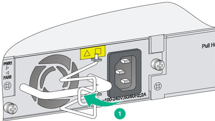
图3-19 PSR150-A1 交流电源线连接示意图（二）
