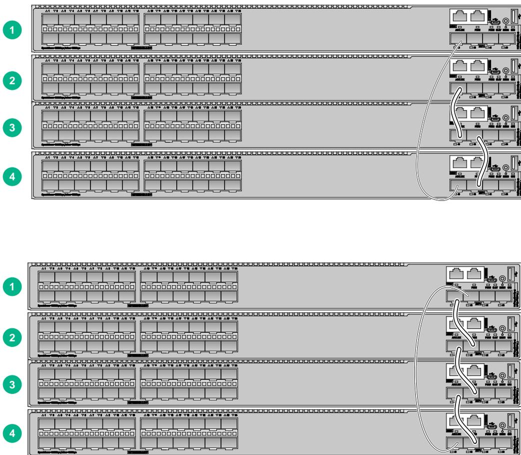
上述连接方式对应的是比较直观的环形拓扑，便于后期维护。拓扑连接关系如[图 5-5](#)所示。
