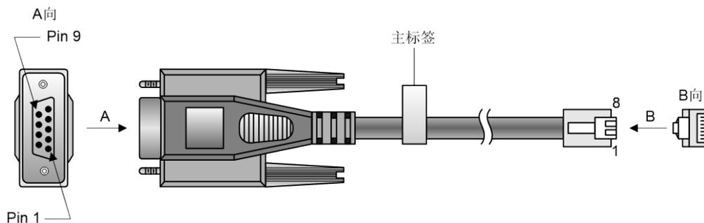
表4-1 串行配置口电缆连接关系
