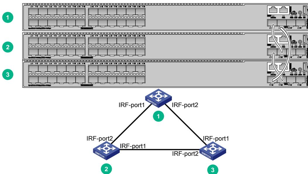
S5600-EI-G 系列交换机能够通过 10GE 以太网端口/SFP+接口提供 10GE 速率的 IRF 物理连接，您可以通过将多个 10GE 以太网端口/SFP+接口与一个 IRF 端口绑定的方式，来实现成员设备间的聚合 IRF 连接。聚合 IRF 连接可以提供更高的性能和可靠性，您可以根据实际需要进行选择。
